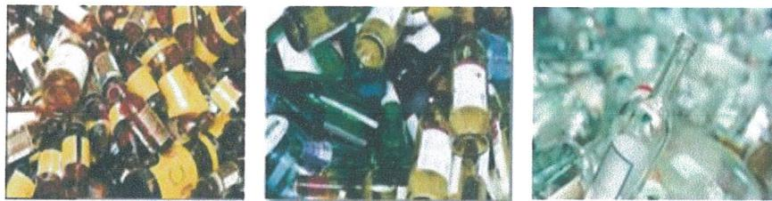
1. ขวดแก้วดี จะถูกนำมาคัดแยกชนิด สี และประเภทที่บรรจุสินค้า ได้แก่ ขวดแม่ข่อง ขวดน้ำปลา ขวดเบียร์ ขวดซอส ขวดโซดาวันเวย์ ขวดน้ำดื่มชูกำลัง ขวดยา ขวดน้ำอัดลม ฯลฯ การจัดการขวดเหล่านี้หากไม่แตกบินเสียหาย จะถูกนำกลับเข้าโรงงานเพื่อนำไปล้างให้สะอาดและนำกลับมาใช้ใหม่เรียกว่า “Reuse”
